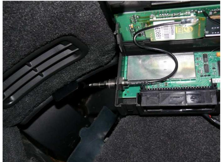
Bild links, Steckplatz SIM Karte – Vergrößerung des Steckplatzes für die SIM-Karte. Die Karte ist nur hineinzuschieben und rastet leicht ein. Durch leichten Druck auf die Hinterkante der SIM-Karte wird sie aufgrund eines Federmechanismus wieder ausgeworfen.
