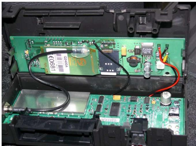
Bild links, AEM von hinten mit Kabel – Ansicht des AEM von hinten mit aufgestecktem Kabeladapter (Verbindung zum Steuerkasten hinten links).
