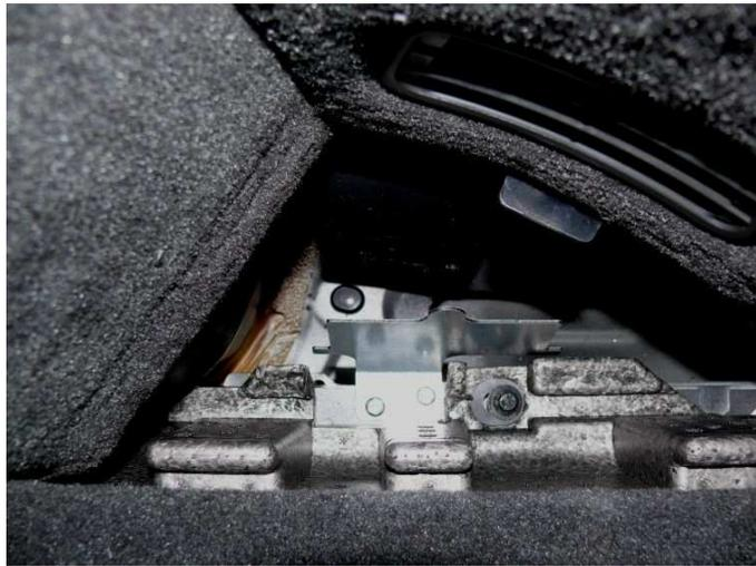
Bild links, AEM eingebaut – Ansicht hinten rechts unter Bodenluke, auf Halterung gestecktes AEM
