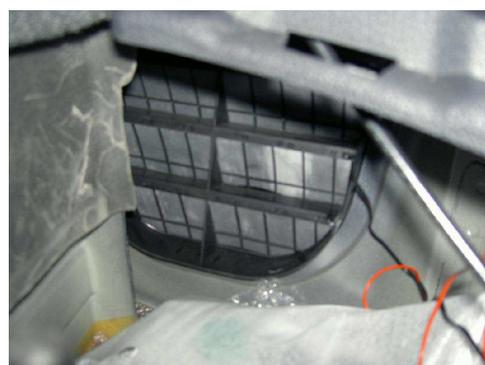
Um Fehlluft zu vermeiden müssen die überstehende Bereiche zugeklebt werden. Dies kann mit Montage- oder Packband geschehen. Dieses fixiert auch noch weiter den Lüfter in der Verrastung. Das hält eigentlich schon bombenfest (siehe Bilder von beiden Lüftern links und rechts).
