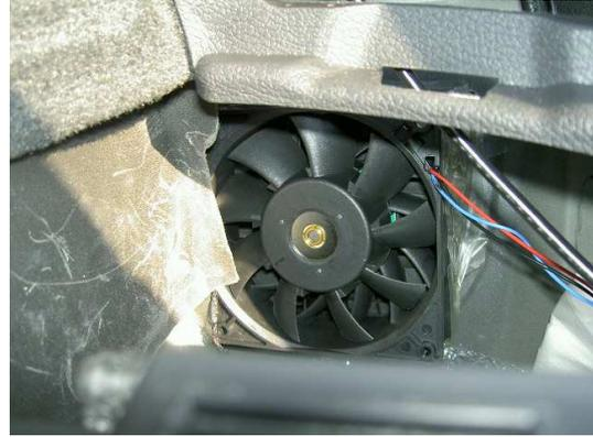
Nun müssen nur noch beide Lüfter mit der Steuerung verbunden werden. Auch die beiden Lüfter schalte ich über die Masse. Plus liegt immer an. Achtung, darauf aufpassen, das keine Kabel an der Karroserie aufscheuern können. Links sollten auch die herum hängenden Kabel zusammen gebunden werden, damit sie nicht in den Lüfter kommen.
